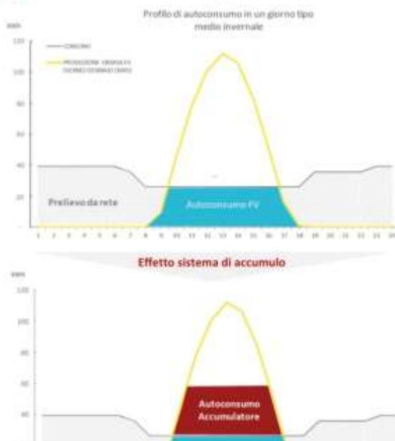
L'impianto è stato dimensionato, a valle di un'attenta **diagnosi energetica**, finalizzata ad analizzare il profilo dei consumi del CAAB, anche tramite verifiche strumentali e misurazioni in campo. Nel corso dell'audit è emersa una **elevata concentrazione dei consumi elettrici nelle ore notturne** (illuminazione e attività mercatali).
